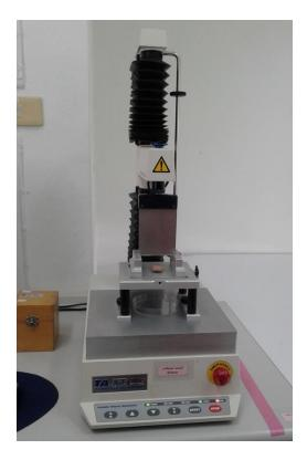
13. กด Start Test เครื่องจะทำการวัดตัวอย่างให้อัตโนมัติ
